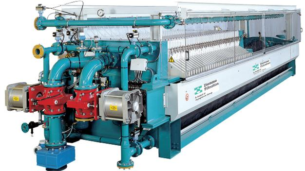
ME es un filtro prensa Diemme® Filtration de viga lateral, extremadamente versátil, lo que permite adecuarse a los requerimientos particulares de cada proceso y de cada cliente. Es completamente automático, con ciclos breves y tiempos muertos reducidos. Gracias al sistema de abertura simultáneo del paquete de placas, la operación de descarga de la torta es rápida e instantánea.
